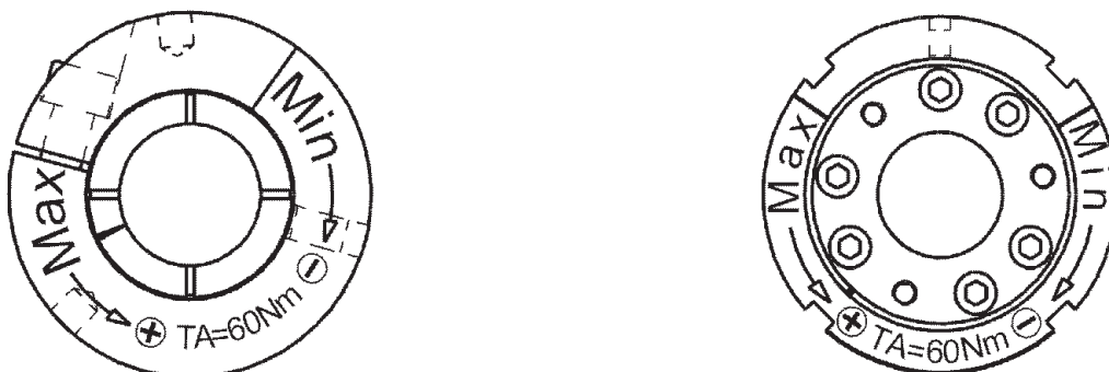
Markierung einer Sicherheitskupplung bei Auslieferung (links: Klemmring; rechts Einstellmutter)
